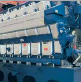
安装滑动垫木的柴油发动机
