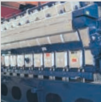
Dieselmotor auf Montagerahmen
