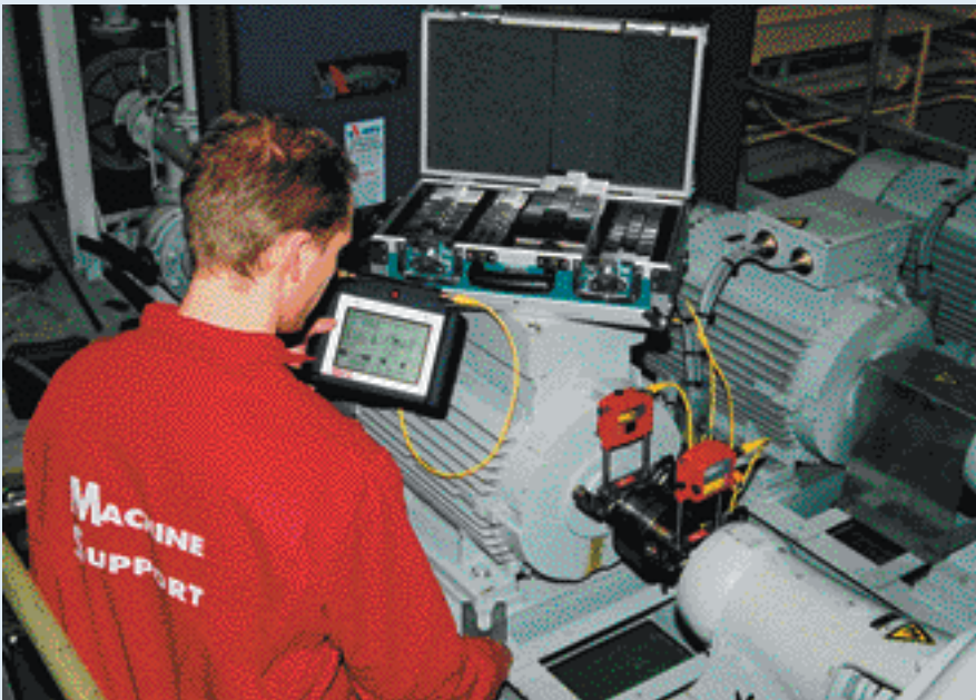
使用Fixturlaser®转轴200和Steelshim®成套填隙片进行快速、准确的轴对中。
