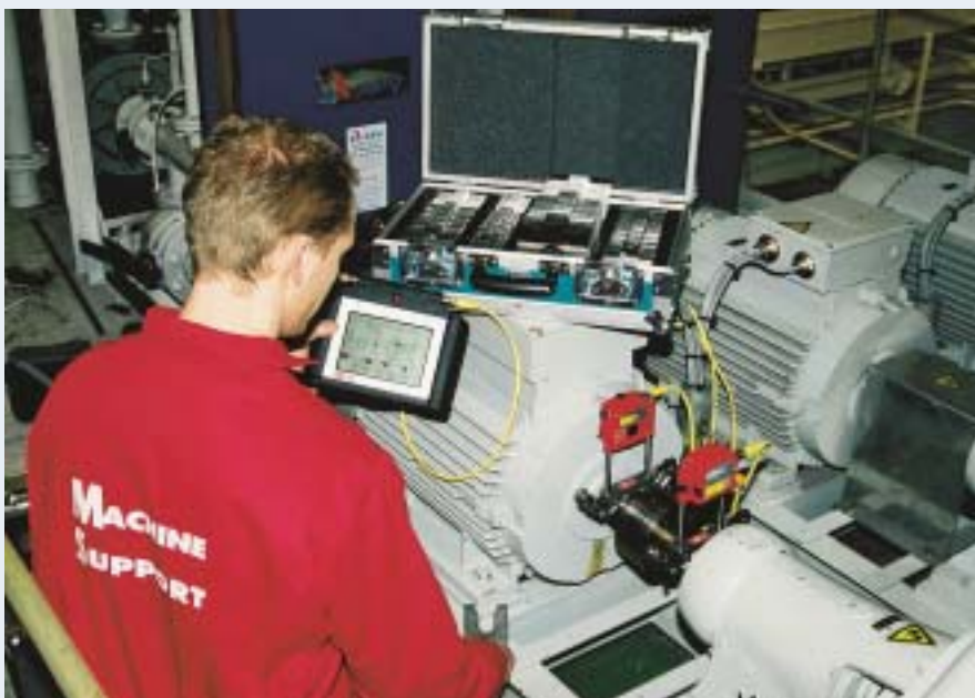
Allineamento rapido e preciso con Fixturlaser® 200 e il corredo di spessori Steelshim®.
