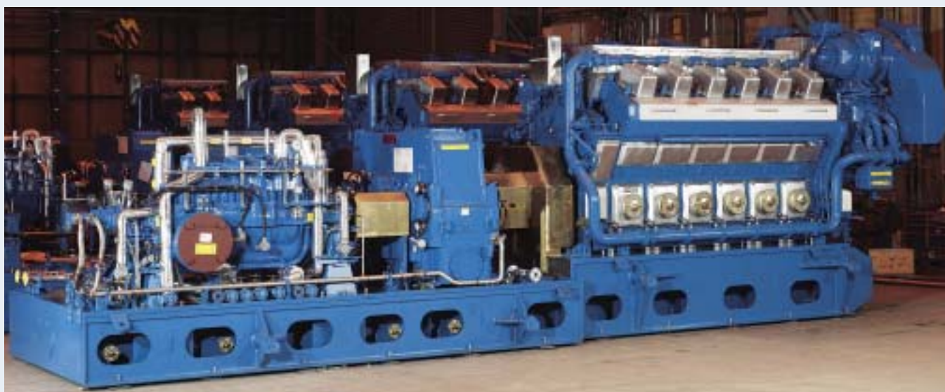
Egyszerű újbeállítást lehetővé tevő Vibracon® SM egységekre szerelt Wártsilä-Sulzer-Lufkin szivattyú egység
