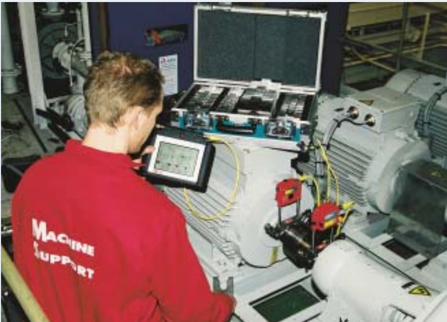
Gyors és pontos tengelybeállítás egy Fixturlaser® Shaft 200 műszerral és Steelshim® hézagoló lemez készlettel.
