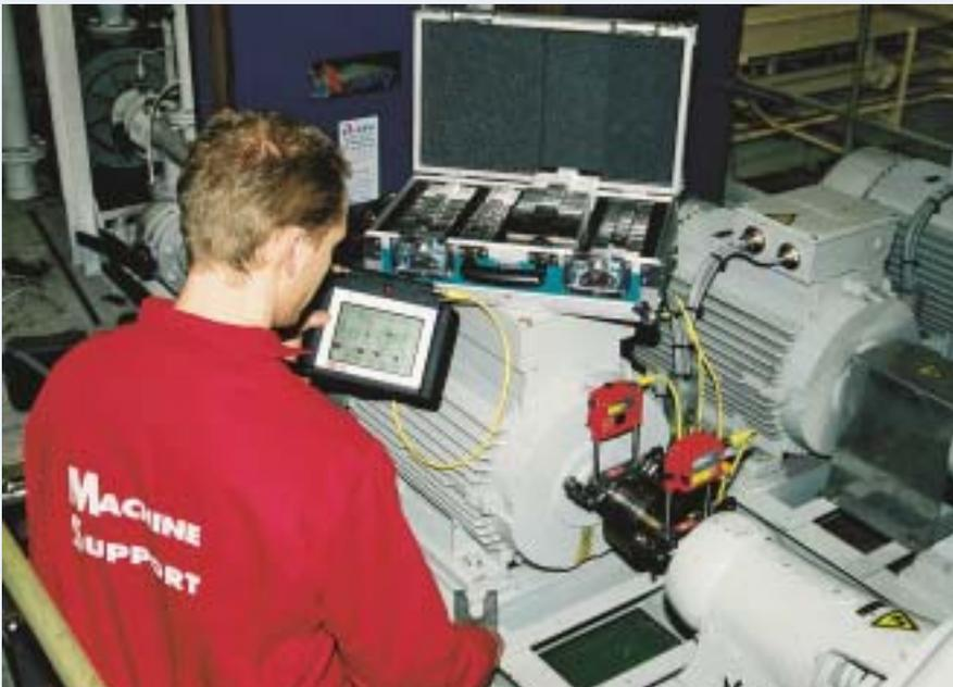
Wellen schnell und genau ausrichten mit dem Fixturlaser® 200 und Steelshim®
